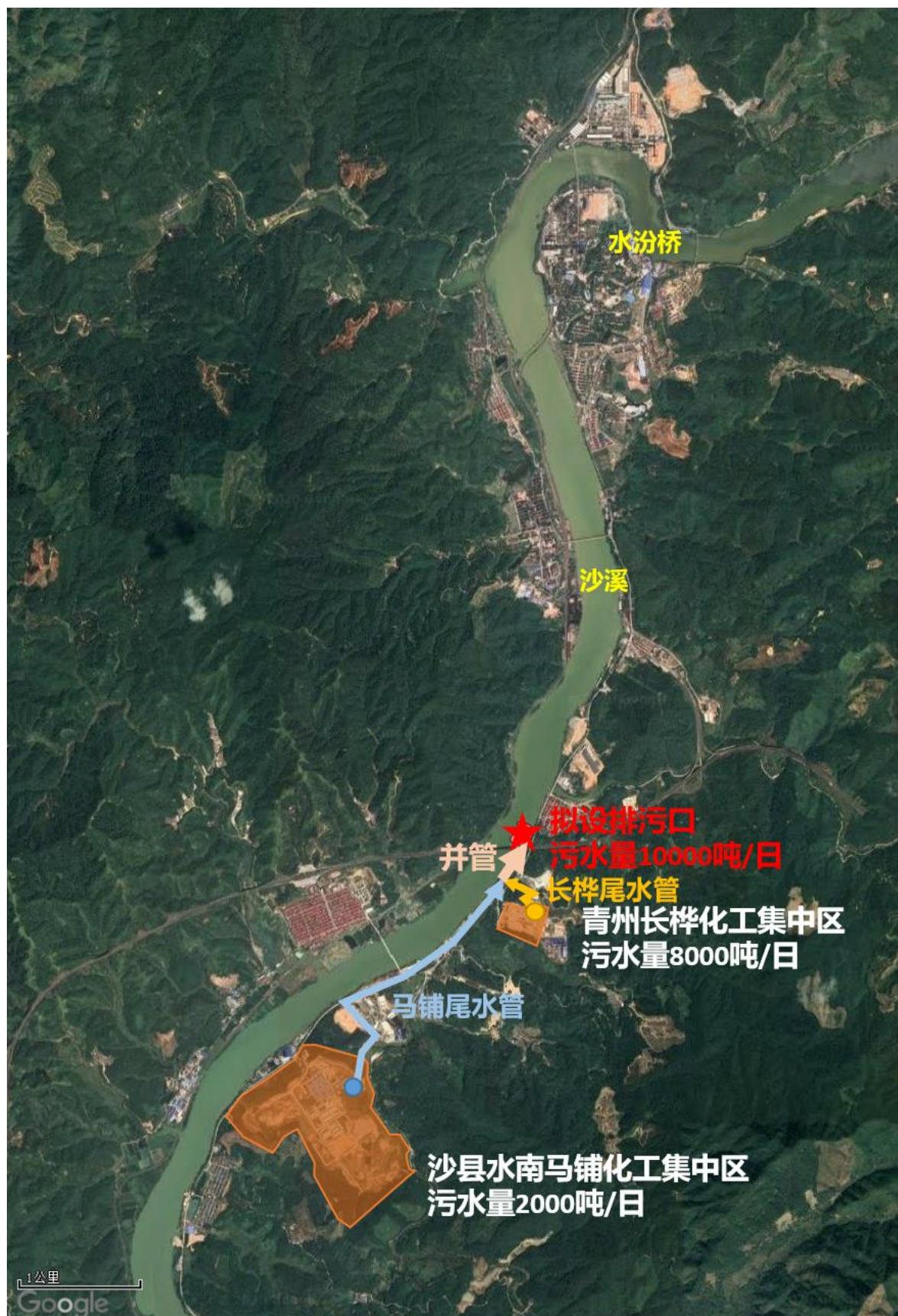
图 5-3 污水处理厂并管入河方式示意图
