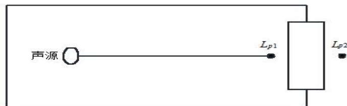
图 4.4-1 室内声源等效为室外声源图例
